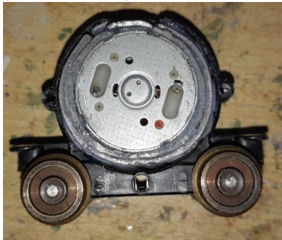
Motorzijde, zonder en met loodstrips als opvulling rond de ModelTorque...
