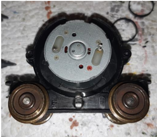
Motorzijde, zonder en met loodstrips als opvulling rond de ModelTorque...
